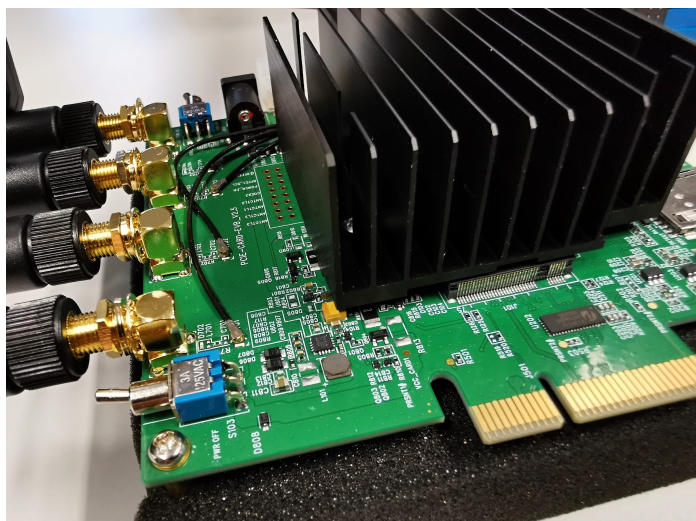
Obr. 2. Propojení modulu k anténním konektorům na EVB (vlevo), kompletní EVB s modulem (vpravo)
