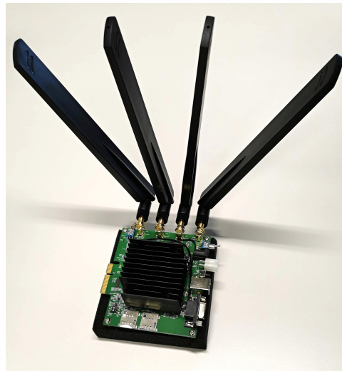
Obr. 2. Propojení modulu k anténním konektorům na EVB (vlevo), kompletní EVB s modulem (vpravo)
